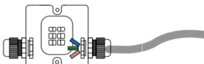
Utilizzare una scatola di giunzione impermeabile (non inferiore IP65) per collegare il cavo di alimentazione o assicurarsi che i cavi siano dotati di trattamento a tenuta stagna.
